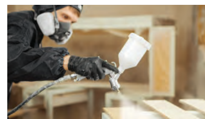
Fig. 30 – Echipament de protecție recomandat la aplicarea vopselelor
