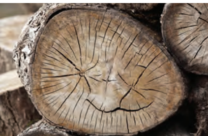
Fig. 19 – Defect de structură, crăpături
