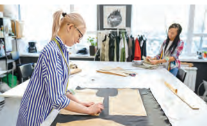
Fig. 20 – Plasarea șabloanelor pe materialul de lucru
