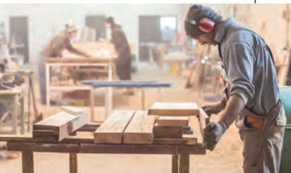
Fig. 32 – Masă de lucru adaptată la dimensiunile corpului executantului
