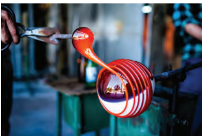
Fig. 13 – Fasonarea manuală a sticlei prin tragere
