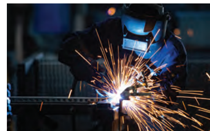
Fig. 26 – Folosirea echipamentului de protecție în timpul operației de sudare
