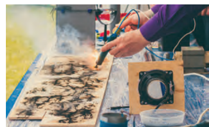
Fig. 44 – Decorare prin pirogravură electrică sau metoda Lichtenberg
