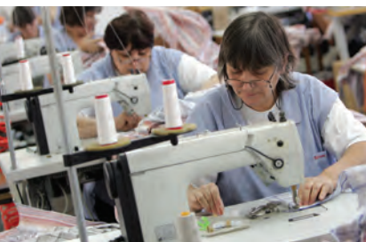
Fig. 21 – Asamblarea prin coasere mecanică, la mașina de cusut
