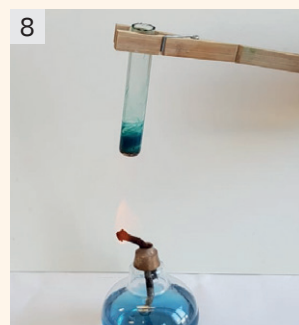
8 Descompunerea hidroxidului de cupru (II), \text{Cu(OH)}_2
