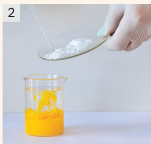
Obținerea iodurii de plumb, \text{PbI}_2
