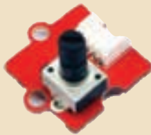
Unghiul rotativ (Rotary Angle) – Un comutator cu un cadran utilizat pentru a controla tensiunea de ieșire.
