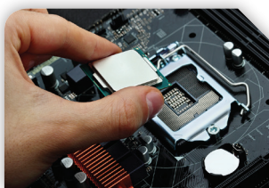
se introduc într-un locaș, unde pinii se află deja pe placa de bază
